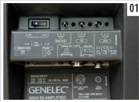
01 Rückwärtiges Anschlussfeld mit Schaltern zur Ortsanpassung und für die Eingangsempfindlichkeit. Der Eingang ist mit je einer XLR- und einer RCA-Buchse ausgestattet.
