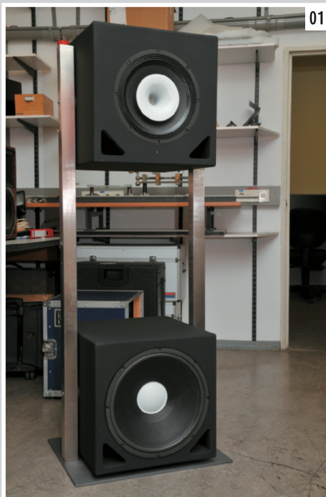
01 Das Test-Setup: C120 im Ständer zusammen mit einem CB150-Subwoofer
