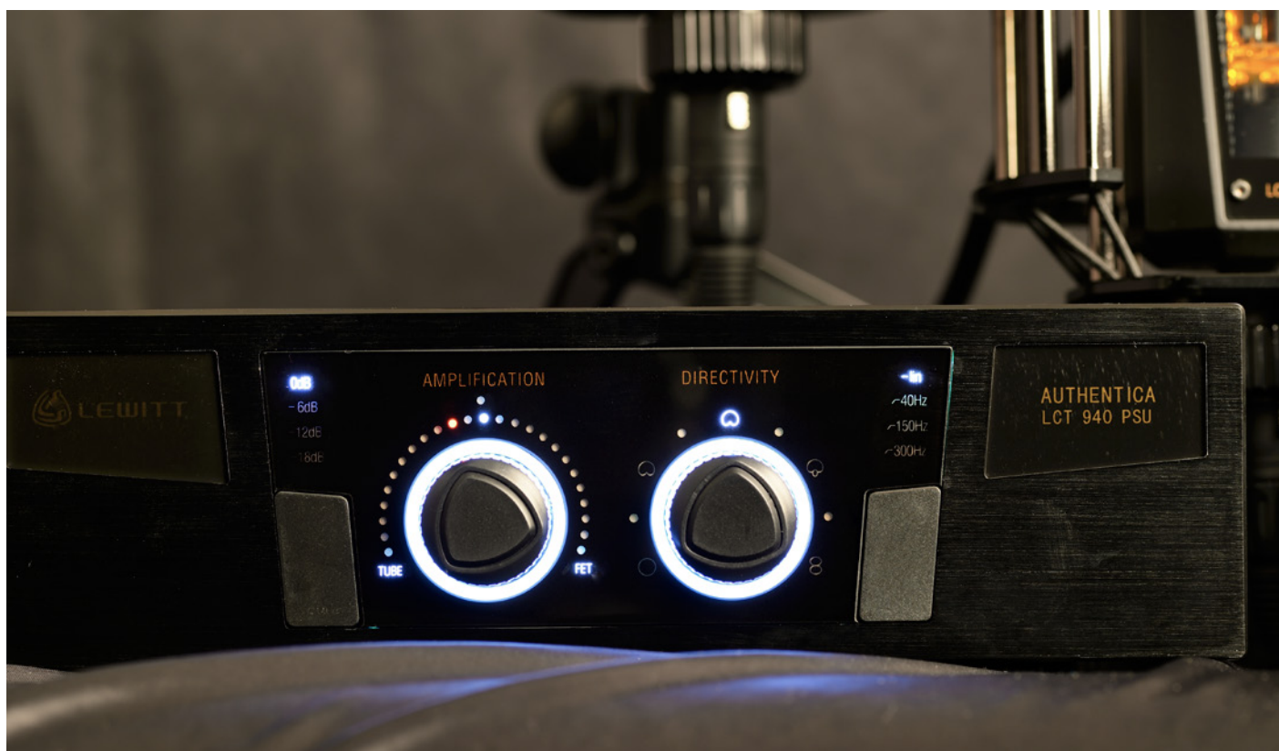
Über den „Amplification“-Drehgeber am LCT 940-Netzteil sind die Klänge des Röhren- und des FET-Verstärkers stufenlos mischbar, was zu Klangexperimenten inspiriert.
