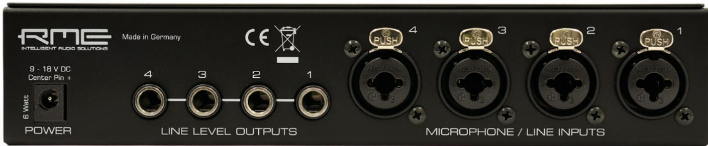
Als Eingänge stehen auf der Rückseite des QuadMic II vier XLR/TRS-Combobuchsen zur Verfügung, die zum Anschluss von Mikrofonsignalen sowie symmetrischen oder unsymmetrischen Line- und Instrumentensignalen dienen.
