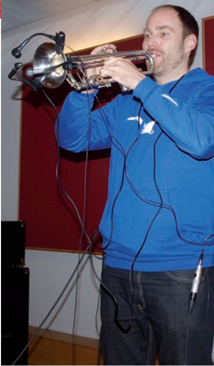
Alle drei Clipmikros – Beyerdynamic TG I57c, Sennheiser e 908 T ew und mein AKG-Mikro – wurden zum Vergleichstest an den Schallbecher der Trompete geklemmt.
