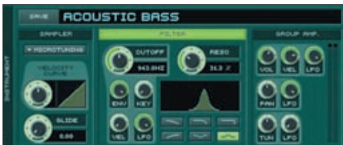
Ein Instrument kann aus einem komplexen, vorgefertigten Multisample bestehen; die Klangformung übernimmt ein Multimodefilter
