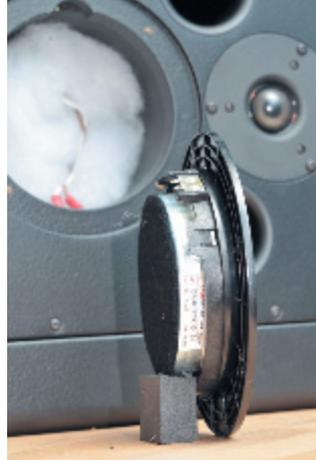
**Die nach hinten offene 3"-Mitteltonkalotte des dänischen Herstellers Scanspeak mit Gewebemembran**
