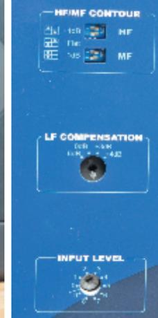
**Schalter auf der Rückseite des Gehäuses zur Pegel-einstellung und Orts-anpassung**
