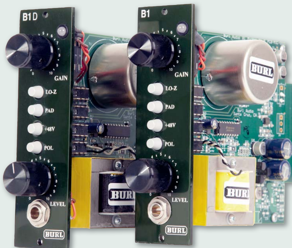
Die beiden Mikrofon-Vorverstärker B1 und B1D sind als API-500-kompatible Module ausgelegt. Besonderheit: Die mächtig wirkenden Ein- und Ausgangsübertrager stammen aus Eigenfertigung. Einziger Unterschied zwischen den Modellen: Der B1-Verstärker besitzt einen Ausgangsübertrager aus Nickel, wohingegen das B1D-Modell mit einem aus Eisen aufwartet und etwas rauer klingt.
