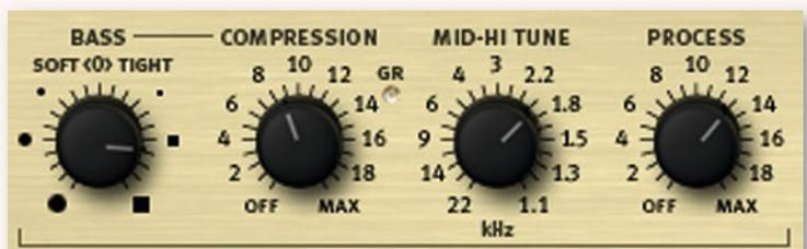
Zentrale Bedienelemente sind der Bass-, Mid-Hi-Tune- und Process-Parameter. Der Mid-Hi-Regler definiert eine Grenzfrequenz, unterhalb derer eine Dämpfung und oberhalb eine Verstärkung der Frequenzen erfolgt. Über den Bass-Regler lassen sich tiefe Frequenzanteile wahlweise weich und rund oder konturiert und perkussiv ausformen. Die Intensität der dahinter arbeitenden Filter wird über den Process-Knopf reguliert.
