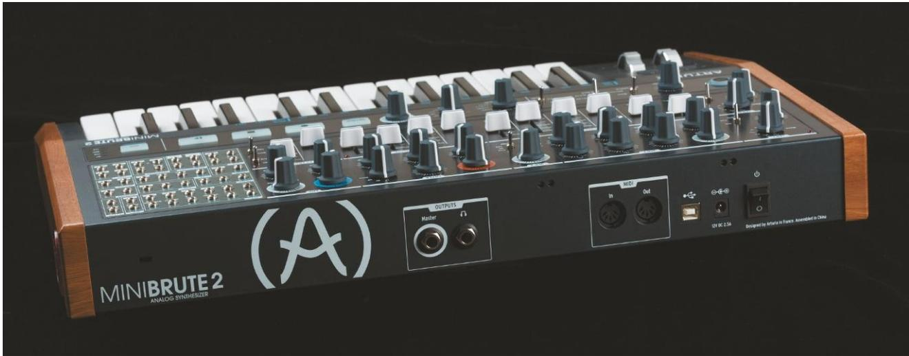
Rückseitig ist der MiniBrute 2 mit folgenden Anschlüssen bestückt: Audio- und Kopfhörer-Ausgang, MIDI-In- und -Out (glücklicherweise als DIN-Buchsen ausgeführt), USB-Anschluss und Buchse für das externe Netzteil.
