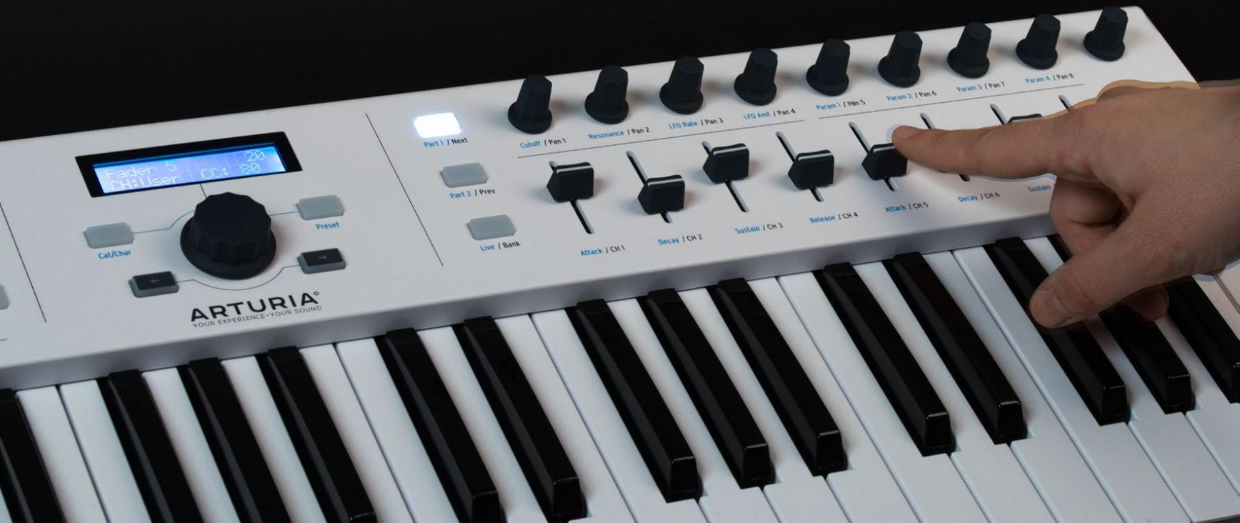
Die Fader regeln unterschiedliche Parameter: im Analog Lab Modus dienen sie der Klangveränderung, im DAW-Modus wird hier die Lautstärke der jeweiligen Spur angepasst.
