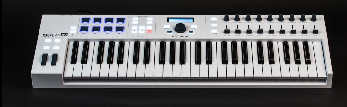
Das Keylab 49 ist mit den Endlosreglern, Fadern, einer DAW-Kontrollsektion sowie Pads und Klaviatur sehr intelligent und platzsparend aufgebaut.
