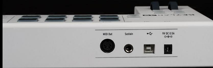
Auf der Rückseite sitzen die Buchsen für MIDI Out, ein Sustain Pedal, das USB-Kabel sowie ein separat erhältliches 9 Volt-Netzteil.
