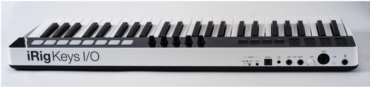
Die Rückseite des iRig Keys verfügt über einen Pedalanschluss, eine Klinke-XLR-Kombobuchse, einen symmetrischen Stereo-Output, einen Kopfhöerausgang sowie einen Mini-DIN-Anschluss, über via USB- oder Lightningkabel Computer oder iOS-Geräte angeschlossen werden.
