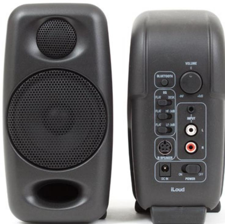
Die Rückseite des linken Monitors: Als Bedienelemente stehen Bluetoothpairing, hohes Shelvingfilter, tiefes Shelvingfilter, Desktopfilter, Powerschalter und Lautstärkereger zur Verfügung, als Anschlüsse Cinch, 3,5 mm-Stereo-Klinke sowie der 4-Pol-Anschluss zur Verbindung der Lautsprecher.
