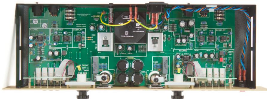
*Das Innenleben des Gold Mike birgt neben einem großzügig dimensionierten Netzteil die beiden 12AX7 (ECC83) Röhren. Wer einen anderen Sound ausprobieren möchte, kann die Werksröhren auch gegen solche vom Typ JJ ECC803 S tauschen – selbstverständlich nur bei gezogenem Netzstecker.*
