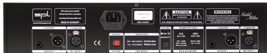
Neben Netzanschluss, Hauptsicherung, Wahlschalter für die Netzspannung und Groundlift Schalter, befinden sich auf der Geräterückseite für jeden der beiden Kanäle ein Eingang in XLR-Ausführung, sowie ein XLR- und ein Klinkeausgang.
