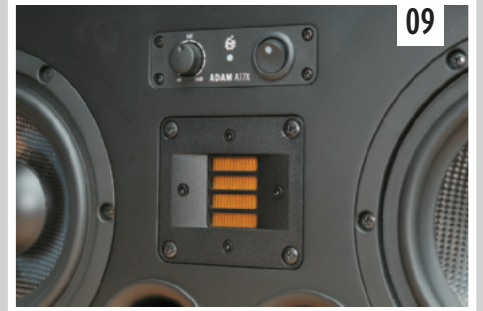
09 Mittig der X-Art Hochtöner, ADAMs Glanzstück in jeglicher Hinsicht. Oberhalb des Hochtöners befinden sich noch der Netzschalter und das Poti für die Eingangsempfindlichkeit.
