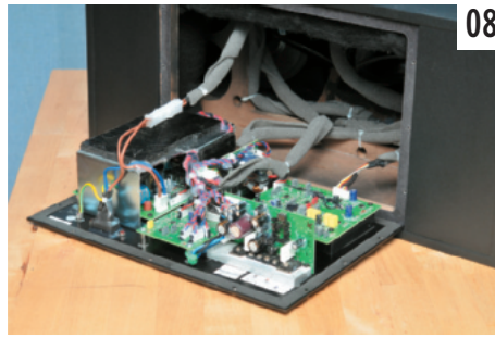
08 Elektronik auf der Innenseite der Rückwand der A77X. Alle größeren Bauteile und Steckverbinder sind verklebt. Die Kabel sind mit Schaumstoff umhüllt.
