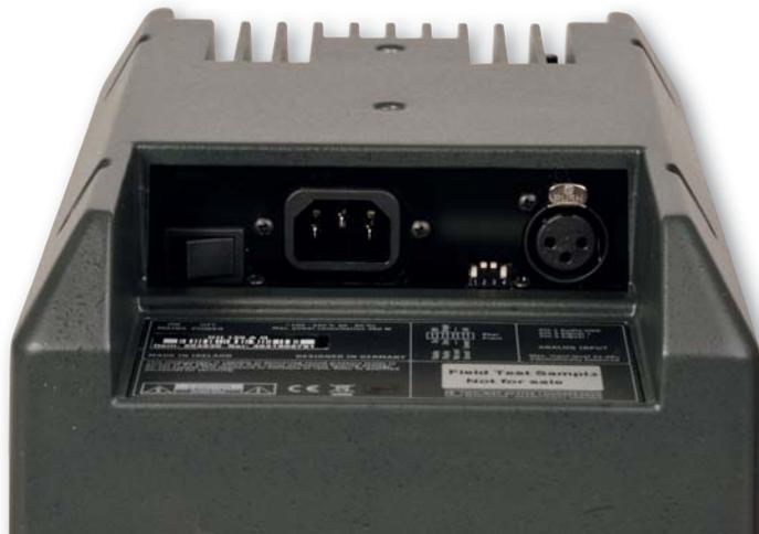
Netzkabel-Anschluss und XLR-Eingang zeigen gen Boden und sitzen versenkt unter dem Kühlkörper. Das Gehäuse besteht aus zwei aus einem Guss gefertigten Aluminiumschalen.
