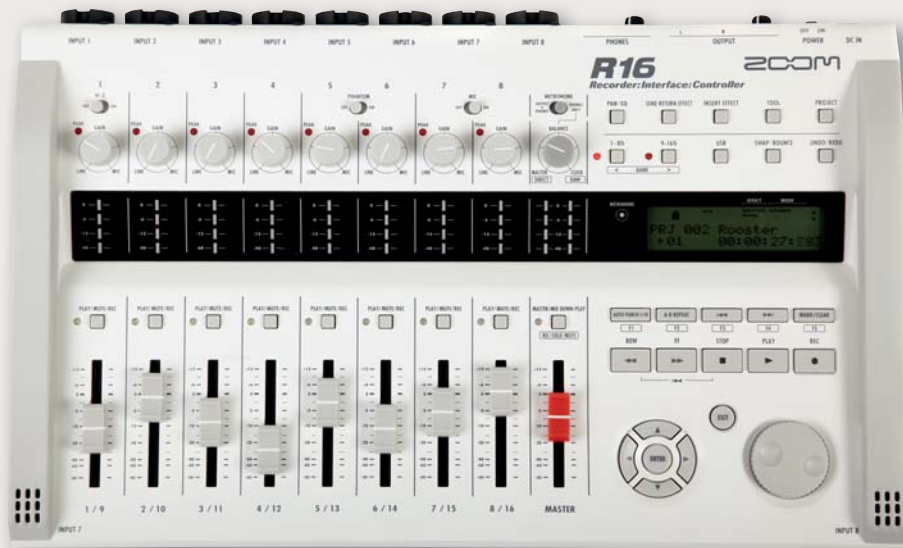
Der Zoom R16 ist klar in Funktionsgruppen unterteilt: Mixer links, Recorder rechts. Die eingebauten Mikrofone vorne links und rechts erlauben ein schnelles Festhalten von Songideen.
