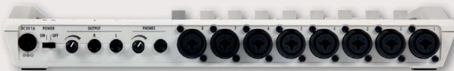
Für die Eingänge wurden platzsparende Combo-Buchsen verwendet. Trotzdem nehmen die Eingänge den meisten Platz auf der Rückseite des flachen R16-Gehäuse ein.
