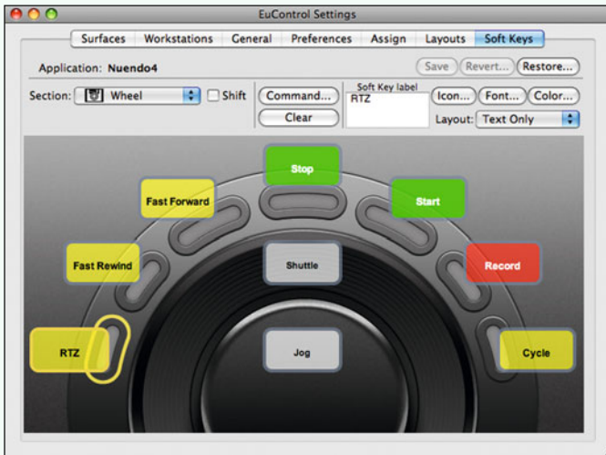
Über den Soft Key Editor der Eucontrol-Software lassen sich komfortabel neue Funktionen auf sämtliche Bedienelemente der Hardware routen und programmieren. Damit kann der MC Transport auch Aufgaben einer Master-Sektion übernehmen.
