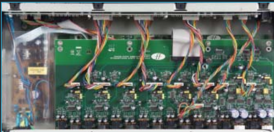
Einen ordentlichen Eindruck hinterlässt das Innenleben des Liquid Saffire 56. Die Elektronik ist auf zwei übereinander angeordnete Platinen verteilt. Die obere Platine verdeckt das untenliegende Mainboard, so dass der DSP für die Emulation der Liquid-Pre-Amps nicht zu sehen ist.
