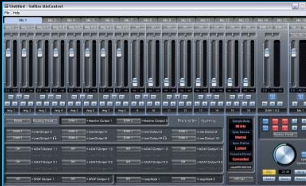
Im integrierten DSP-Mixer des Liquid Saffire 56 lassen sich bis zu 16 Monitor-Mischungen erstellen. Der große Monitorregler rechts unten lässt sich von der Hardware fernbedienen und regelt bis zu zehn physikalische Ausgänge.
