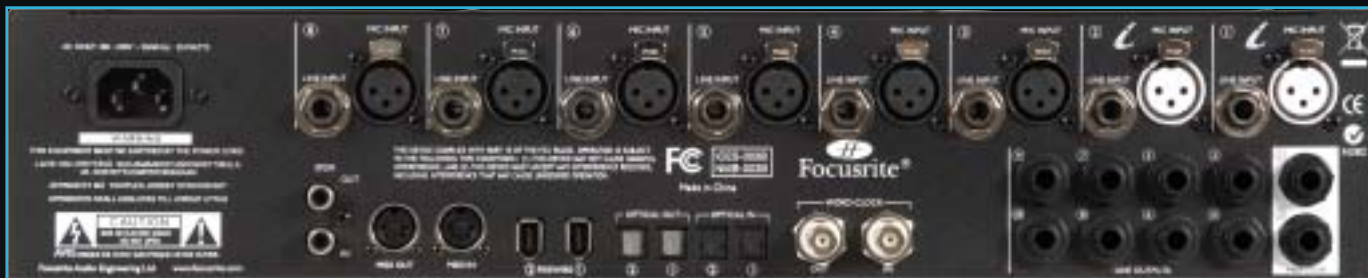
Die Rückseite vereint acht analoge Eingänge mit XLR- und Klinkerbuchsen. Mit einer koaxialen S/PDIF- und zwei ADAT-Schnittstellen werden bis zu 26 Eingänge realisiert.
