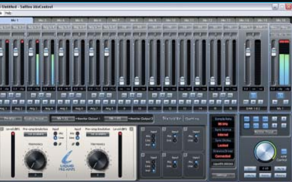
Neu in der Saffire Control-Software ist die Steuerung der beiden Liquid Pre-Amps. Bis zu 10 Emulationen lassen sich auswählen und mittels Harmonics-Regler verfeinern.
