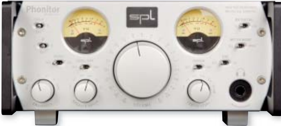
Der Phonitor ist ein einkanaliger Kopfhörer-Verstärker, der sich gezielt an Toningenieure wendet. Über die Crossfeed-, Speaker-Angle- und Center-Level-Dreheschalter erzeugt er die Simulation einer Abhörakustik von Lautsprechern im Kopfhörer. Mono-, Solo- und Phasenumkehr-Schalter bereichern den Phonitor um zusätzliche nützliche Funktionen.
