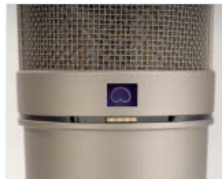
Beim altbewährten Klassiker Neumann U 87 Ai erfolgt die Wahl der Richtcharakteristik über einen präzise rastenden mechanischen Schalter.
