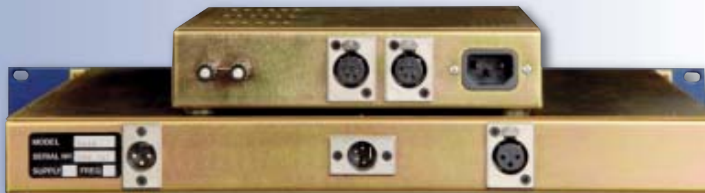
Der Germanium benötigt ein separates Netzteil, der Hersteller empfiehlt das PSU-1 MKII (hier auf dem Vorverstärker), das Gerät arbeitet aber auch mit den Netzteilen der TG-Serie.
