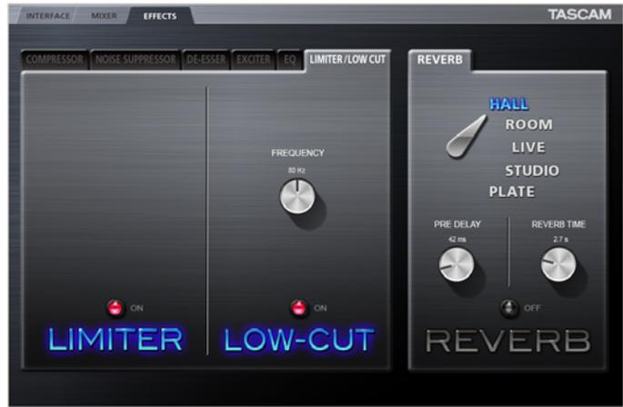
Eine Ausnahme bildet das Insert-Effekt-Paar Limiter und Hochpassfilter. Beide lassen sich bei 44,1 oder 48 Kilohertz auch gemeinsam einsetzen – in diesem Fall entfällt der zusätzliche Send-Effekt.
