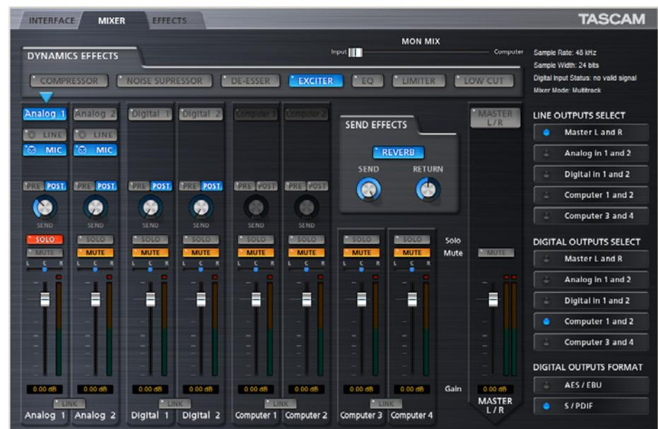
Die Mixeroberfläche der UH-7000-Bediensoftware gliedert sich in einen mit Effekten versehenen Kanalzug-Bereich und einen Abschnitt für das Ausgangs-Routing.
