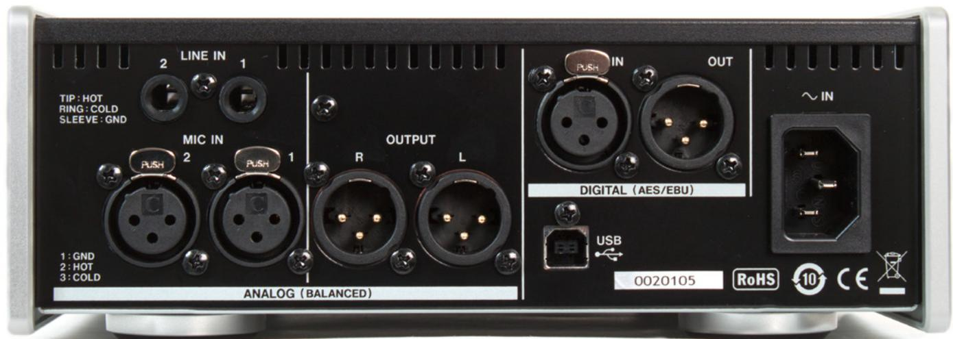
Alle Anschlüsse auf der Rückseite des UH-7000 sind solide verbaut und separat mit dem Gehäuse verschraubt.
