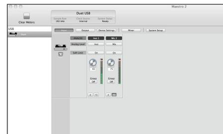
Die Mixer- und Steuersoftware Maestro 2 wird zusammen mit den Treibern installiert: Grundlegende Einstellungen wie Ein- und Ausgangs-Routings (links), die Belegung der Touchpads des OLED-Displays (Mitte) und die Einrichtung der Eingänge (rechts) sind damit schnell erledigt.
