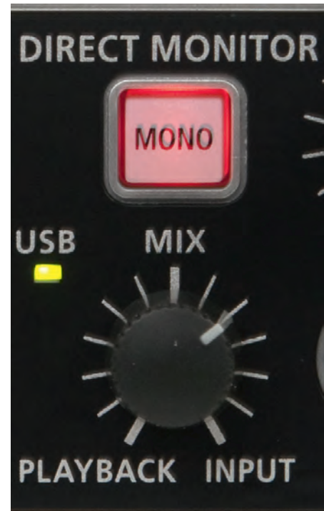
Der Mix-Regler bestimmt das Verhältnis von direktem Eingangssignal und Playback-Stream. Auf 12 Uhr sind beide zu gleichen Teilen zu hören.
