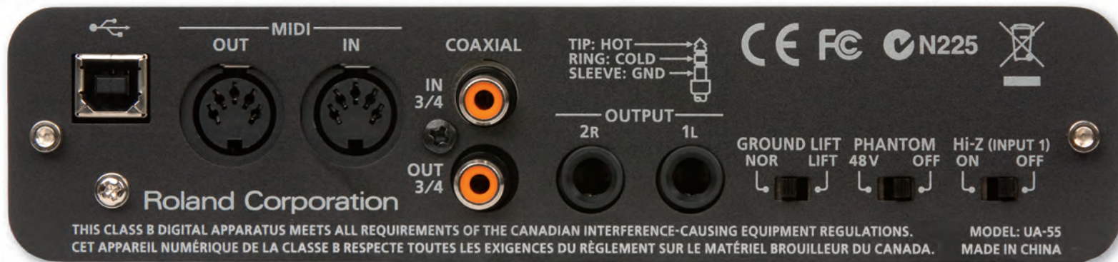
Die Phantomspannung lässt sich für beide Preamps ein- oder abschalten, je nach dem ob Kondensatormikrofone zum Einsatz kommen.
