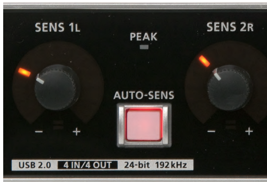
Wer möchte, kann die Eingangspiegel mit spitzen Fingern manuell vornehmen. Einfacher geht's mittels interner Pegelanalyse mit der praktischen Auto-Sens-Funktion.
