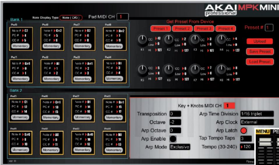
In der mitgelieferten Editor-Software kann man u. a. Pads und Regler frei mit MIDI-Befehlen belegen. Diese Konfigurationen lassen sich im MPKmini in vier Presets sichern und abrufen.
