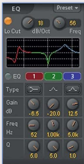
Die TotalMix FX Channelstrips enthalten einen parametrischen Drei-Band-Equalizer sowie ein zuschaltbares Hochpass-Filter.
