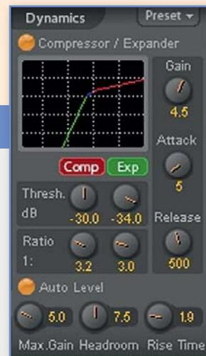
An Dynamik-Effekten steht ein simultan nutzbarer Kompressor und Expander sowie mit Auto-Level eine Art Limiter zur Verfügung.
