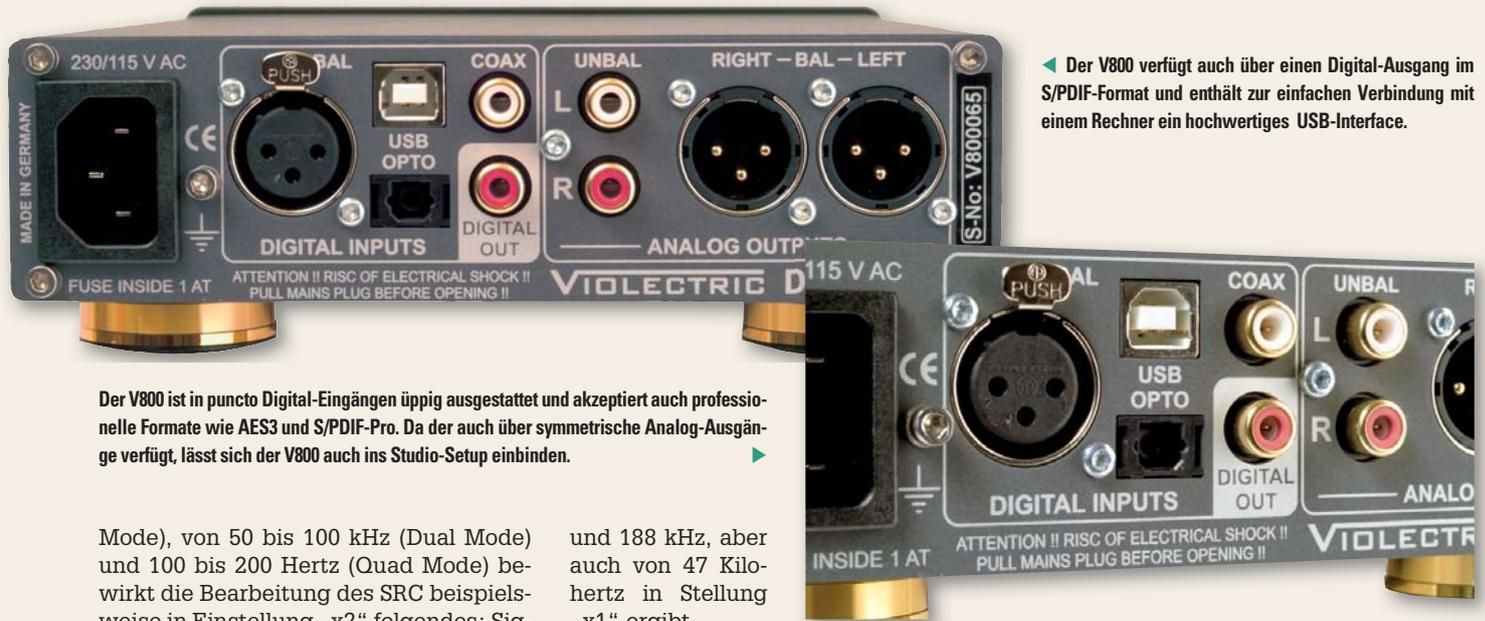
◀ Der V800 verfügt auch über einen Digital-Ausgang im S/PDIF-Format und enthält zur einfachen Verbindung mit einem Rechner ein hochwertiges USB-Interface.
