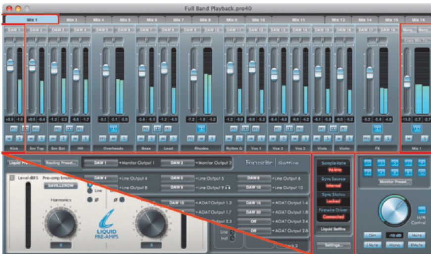
Das Mixer-Panel bietet komplexe Möglichkeiten mit individuellen Monitor-Mixes, einem weitgehend freien Routing und einer Auswahl von zehn Emulationen für die Liquid-Preamps.
