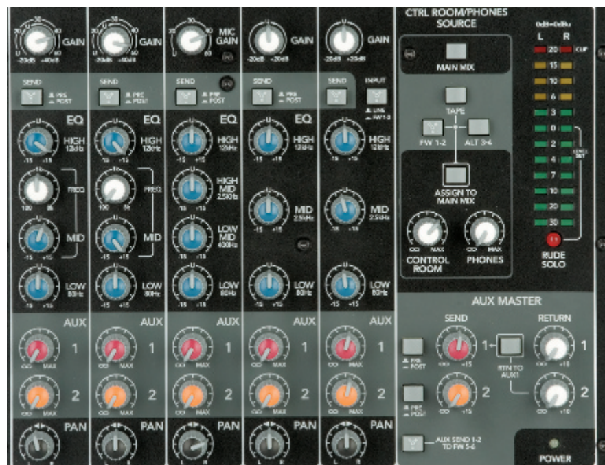
Perkins-Equalizer, Aux-Sends und Control-Room-Sektion. Hier besonders zu beachten: diverse Schalter mit FireWire-Symbol.
