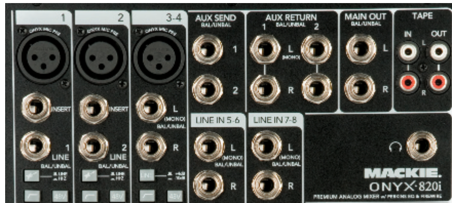
Alle Eingänge sowie Anschlussmöglichkeiten der Aux-Kanäle oder Tape-Quellen finden sich an der oberen Kante.
