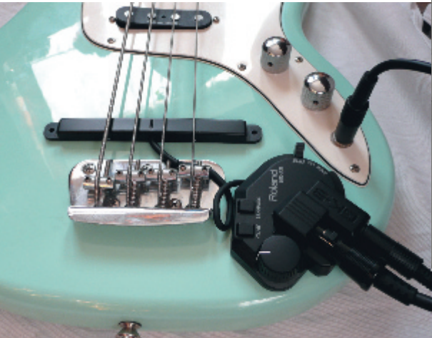
GK-3B-Tonabnehmer und -Controller per Klebestreifen am Testbass montiert
