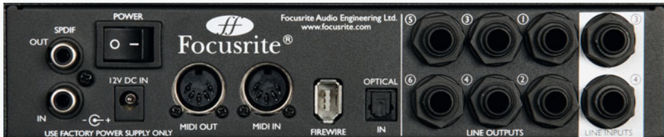
Die Rückseite bietet zwei analoge Eingänge mit symmetrischen Klinkenbuchsen. Mit einer koaxialen S/PDIF- und einer ADAT-Schnittstelle stehen maximal 14 Eingänge bereit.
