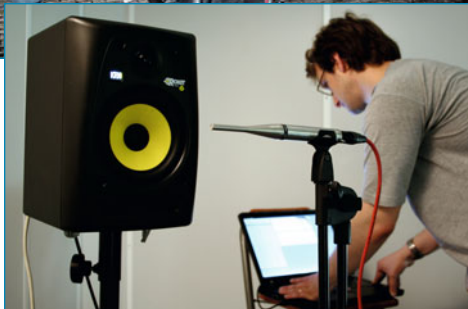
▲ Das Impuls- und Abstrahlverhalten von Lautsprechern wurde gemessen, um möglichst naturgetreue Nachbildungen für die Lautsprecheremulation zu erstellen.
