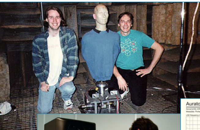
◀ Das Modell eines Hörers wurde erstellt, um genaue Werte zu Schallbeugungen und Körperreflexionen zu erhalten. Aus den Impulsantworten wurde eine kopfbezogene Transferfunktion errechnet, die das Gehör für die Lokalisation von Schallquellen heranzieht.
