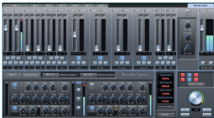
Die Mix Control-Software steuert den DSP-Mixer des Saffire Pro 24 DSP. In den Eingängen eins und zwei lassen sich Kompressoren und Equalizer aktivieren. Der sogenannte Comfort Reverb dient als reiner Monitor-Reverb für den einspielenden Musiker.
