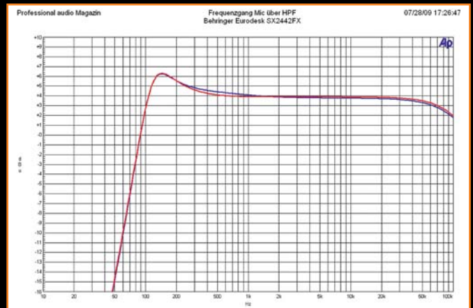
Der Frequenzverlauf ist bis über 20 Kilohertz linear. Das Hochpassfilter unterdrückt effektiv Rumpelgeräusche, weist aber auch eine kräftige Bassanhebung auf.
