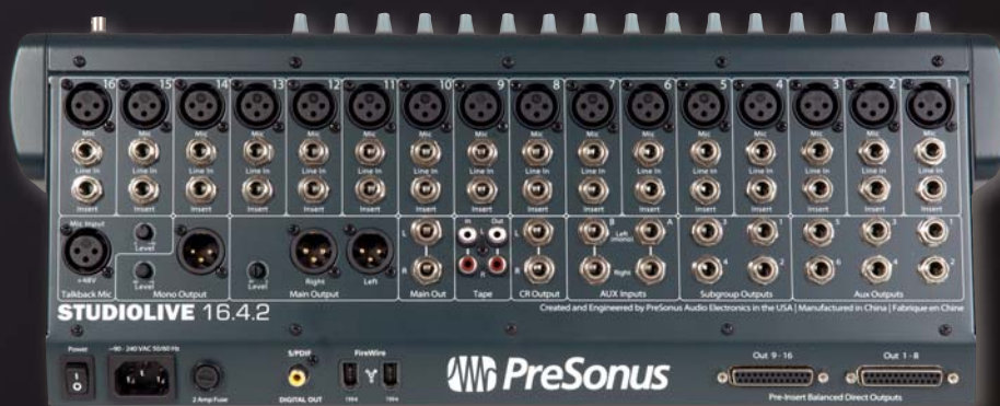
Anschlüsse satt, lautet das Motto beim StudioLive 16.4.2. Hinter den beiden DB25-Buchsen verbergen sich die Direct outs. Besonderheit: Gain-Potis bei den Stereo- und Mono-Main-Ausgängen sowie dem Talkback-Eingang erlauben ein Anpassen der Lautstärke unabhängig von der Stellung der Fader.
