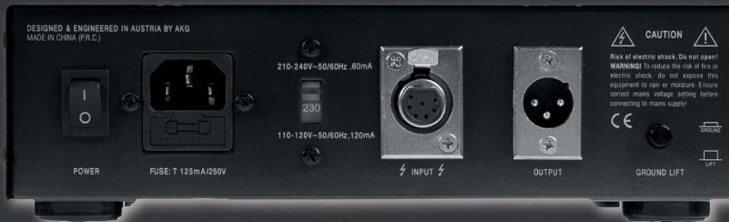
Der Ground-Lift-Schalter ist zwar etwas fummelig, erfüllt aber bei auftretenden Brummschleifen seinen Zweck.
