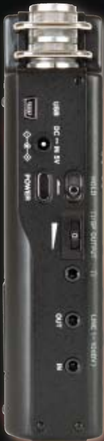
Der DR-100 bietet neben seinen internen Mikrofonen auch einen Line-Eingang sowie einen Kopfhörer- und Line-Ausgang.
