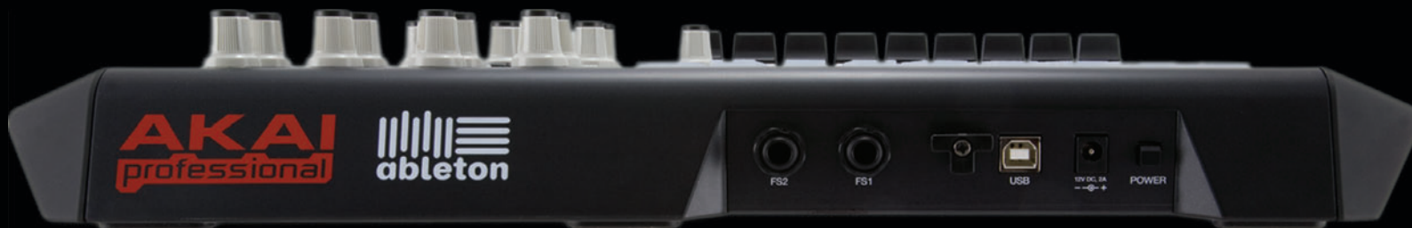
Neben dem USB-Port finden sich auf der Rückseite des APC40 zwei Anschlüsse für Fußschalter sowie für das notwendige Netzteil.
