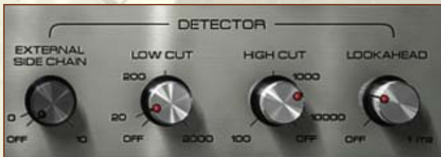
Die Detector-Sektion erweiterte die Funktionalität des FET Compressors um einen externen Sidechain, interne Sidechain-Filter, sowie eine wirkungsvolle Lookahead-Funktion.
