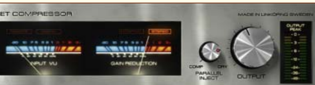
Zum Überblenden zwischen komprimiertem und unkomprimiertem Signal (New Yorker-Kompression), bietet der FET Compressor den praktischen Parallel-Inject-Regler.
