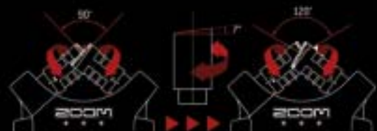
Zwei eingebaute professionelle Kondensatormikrofonkapseln in X/Y-Drehschaltung mit zwischen 90° und 120° verstellbarem Aufnahmewinkel
