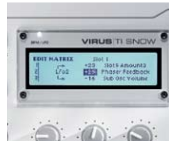
Die Mod-Matrix des Snow besitzt sechs Slots, die jeweils gleichzeitig eine Quelle auf drei Ziele leiten können und auch Cross-Modulationen innerhalb der Matrix erlauben.
