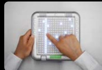
Noten werden über eine 16 mal 16 Buttons zählende Matrix eingegeben.
