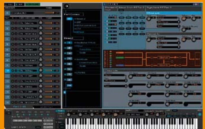
Im Multimodus können bis zu 16 Parts auf unterschiedlichen MIDI-Kanälen angesprochen und individuell mit Effekten belegt werden. Maximal vier Parts lassen sich für Klangkombinationen übereinander schichten.
