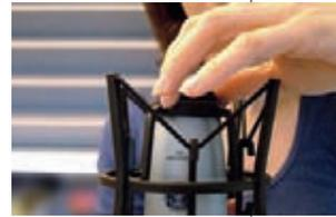
**2 AUFBAU:** Nein, unsere Sängerin zeigt dem Produzenten hier nicht die lange Nase, sondern liefert eine beliebte Einstellhilfe: Daumen und kleiner Finger bilden eine Diagonale, die genau auf die Mikrofonkapsel zeigen sollte. Durch die etwas erhöhte Position des Mikrofons liegt der Kopf beim Singen leicht im Nacken, was meist einen befreiten, offeneren Klang der Stimme zur Folge hat ▶▶
