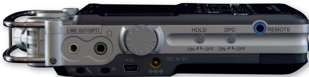
Stichwort Fernauslöser: Um Handgeräusche und Trittschall bei Aufnahmen zu vermeiden, kann der PCM-D50 ferngesteuert werden. Dazu muss eine Fernbedienung (RM-PCM1) an die blaue Remote-Buchse angeschlossen werden. Sie lagert die Funktions-Tasten Rec, Stop, Pause und Divide aus.
