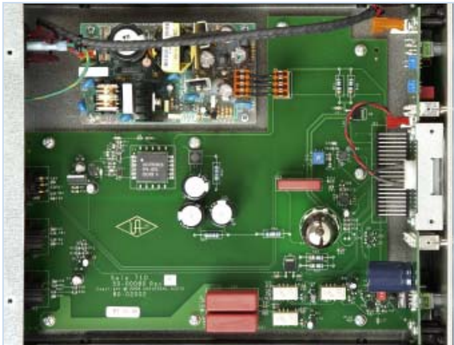
Verantwortlich für den Röhrensound ist eine Doppeltriode (ECC83s) des slowakischen Herstellers JJ.
