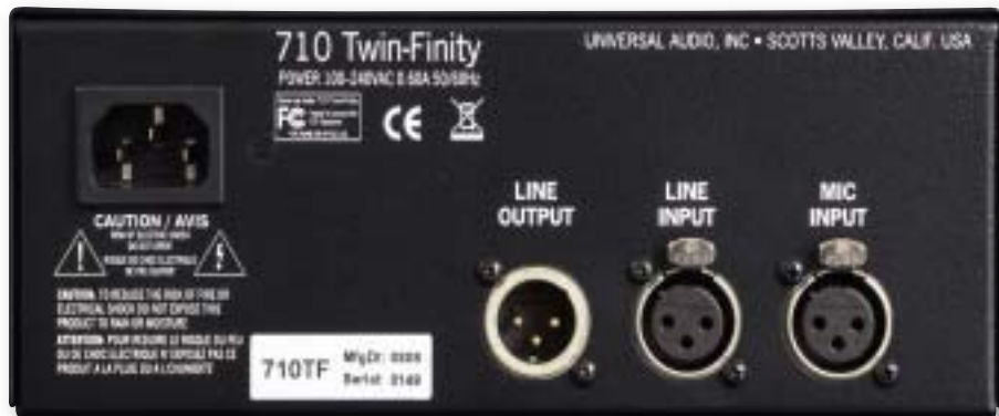
Der separate Line-Eingang ist erst dann aktiv, wenn der zugehörige Wahlschalter auf der Fronplatte umgelegt ist.
