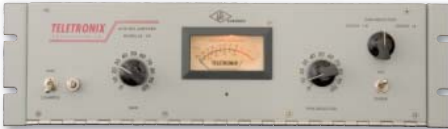
Der LA-2A kommt mit wenigen Bedienelementen aus: der Peak-Reduction-Regler ist zuständig für die Stärke der Kompression und den Schwellenwert, der Gain-Regler bestimmt den Ausgangspegel.
