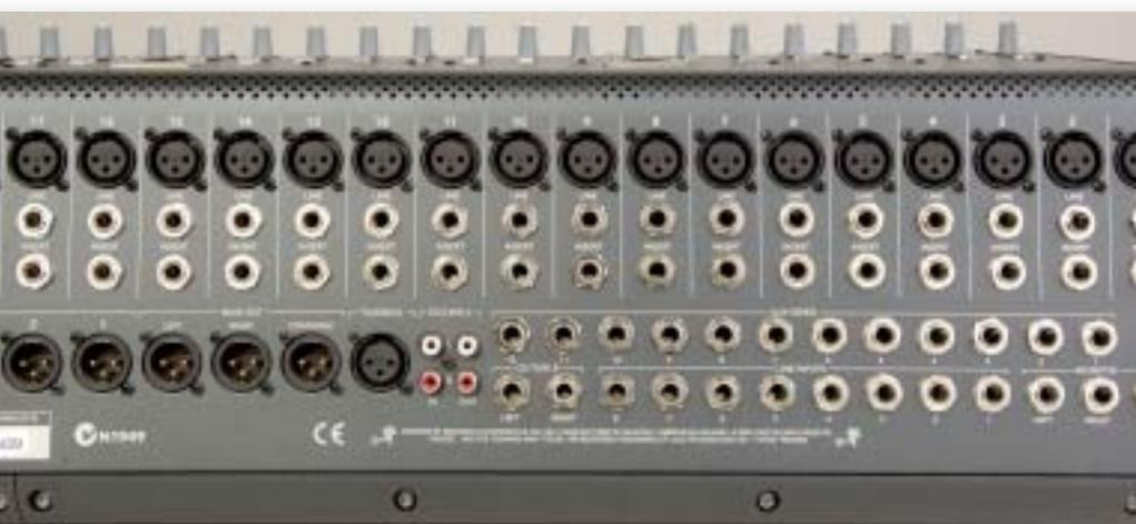
Auf der Rückseite versammeln sich: 24 Mic-, Line- und Insertbuchsen. 12 Aux-Sends, 8 zusätzliche Line-Inputs und 8 Group/Matrix Outputs: und das ist noch nicht alles.
