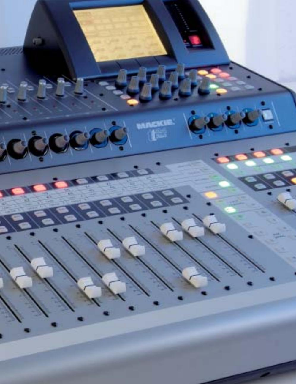
mit 28 dazugehörigen multifunktionalen Drehreglern – nur über dem Master-Fader befindet sich stattdessen eine Leerstelle. Beleuchtete Solo-, Mute- und Select-Knöpfe sind in jedem Kanalzug installiert. Die Fader-Bereiche für die Kanäle und die Aussteuerung der Subgruppen plus Masterfader sind durch ein Kontrollfeld mit weiteren Knöpfen getrennt. Diese dienen der Funktionszuweisung der Drehregler sowie dem Umschalten der vier Fader-Bänke.
