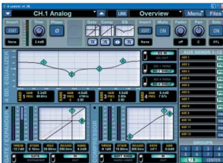
Das Overview-Fenster ermöglicht die Kontrolle über alle Einstellungen eines Channel-Strips.
