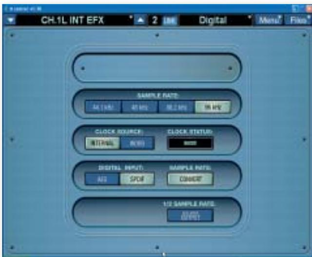
Die Samplingfrequenz ist von 44,1 kHz bis 96 kHz einstellbar.
