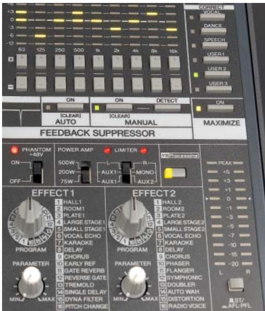
In der Digital-Sektion hält der MX5016CF einige Zusatzfeatures bereit. Nicht nur 32 digitale Effekte und einen neunbandigen EQ, sondern auch einen Summenkompressor, effektives Feedback Suppression und ein Frequency Response Correction System.
