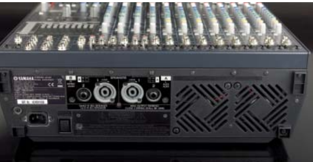
Hinter den Lüftungsschlitzen befinden sich die leistungsstarken Endstufen. An sichere Speakon-Buchsen für die Lautsprecher wurde auch gedacht.
