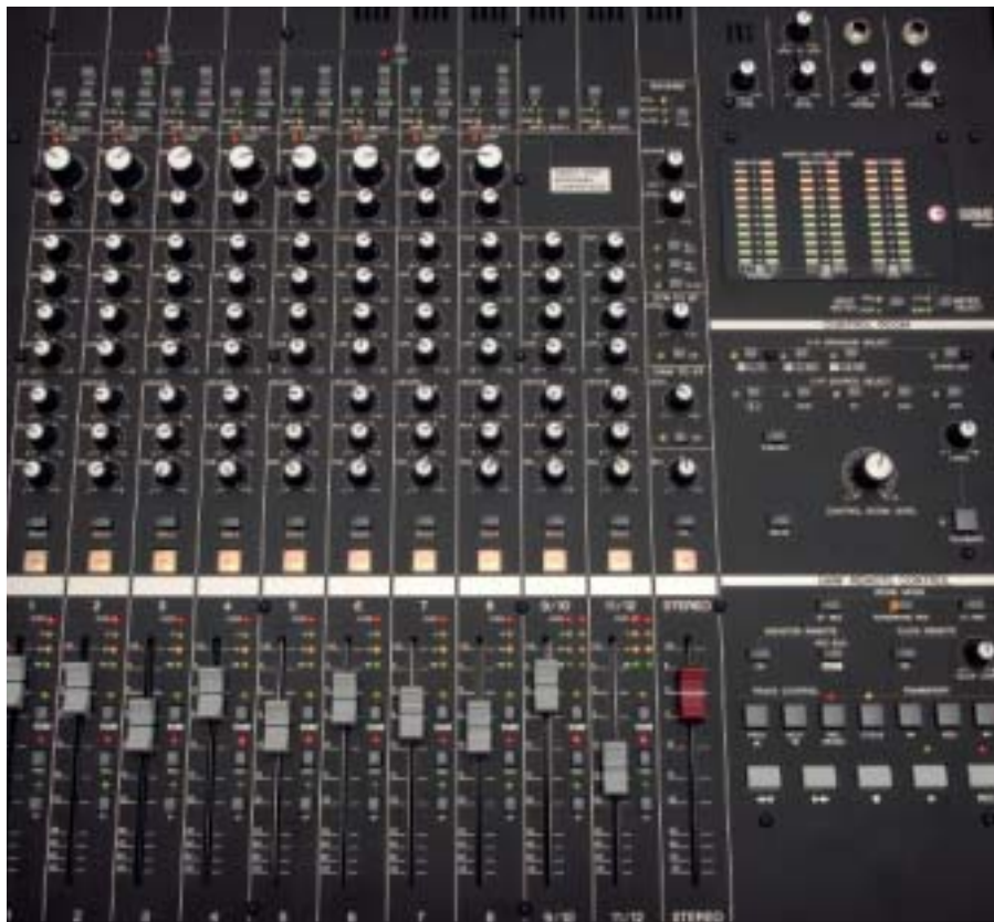
Das zwölfkanalige Yamaha n12-Mischpult ist bis auf die verbauten Class-A-Mikrofon-Vorverstärker komplett digital ausgelegt. Es ist gezielt auf die Zusammenarbeit mit dem Cubase-Sequencer hin optimiert worden.
