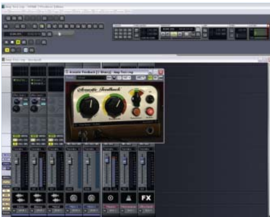
Acoustic Feedback imitiert Rückkopplungen und sollte direkt beim Einspielen zum Einsatz kommen. Mit einem übersteuereten Verstärker wie dem White-Amp, der sich im Lieferumfang des Plug-ins befindet, bekommt der Gitarrist erstaunlich realistische Feedbacks, die er gezielt beim Spielen/Aufnahmen einsetzen kann.
