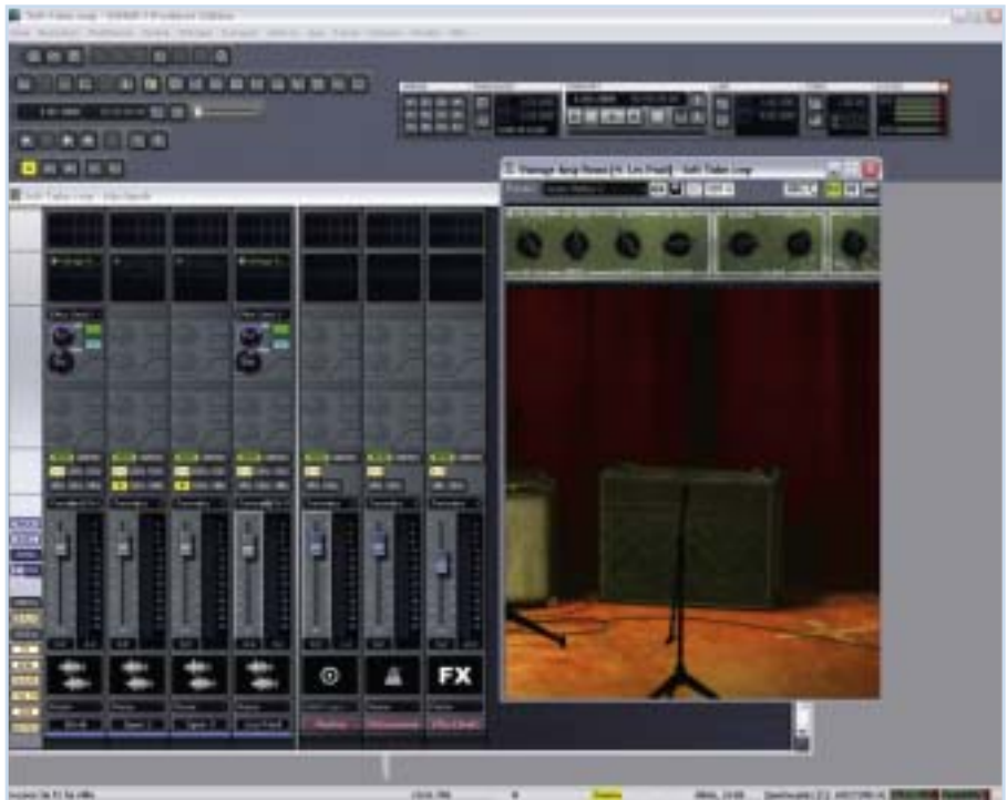
Der „Green“-Amp, eine Emulation des Vox AC30 ist dem Vorbild grafisch exakt und klanglich sehr präzise nachempfunden. Das im Room verschiebbare virtuelle Mikrofon (Shure SM57) lässt sich sowohl „On Axis“ als auch „Off-Axis“ vor den Lautsprechern positionieren.
