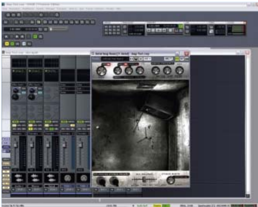
Bei der zweiten Box im Metal Amp Room handelt es sich um den Software-Nachbau einer neuen Marshall 4 x 12. Für die Mikrofonierung gibt es zwei virtuelle Mikrofone (Shure SM57 und AKG C 414). Das Mischverhältnis und die Stereo-Basisbreite sind stufenlos einstellbar (unten im Bild). Auch ein Phasenumkehrschalter fehlt nicht.
