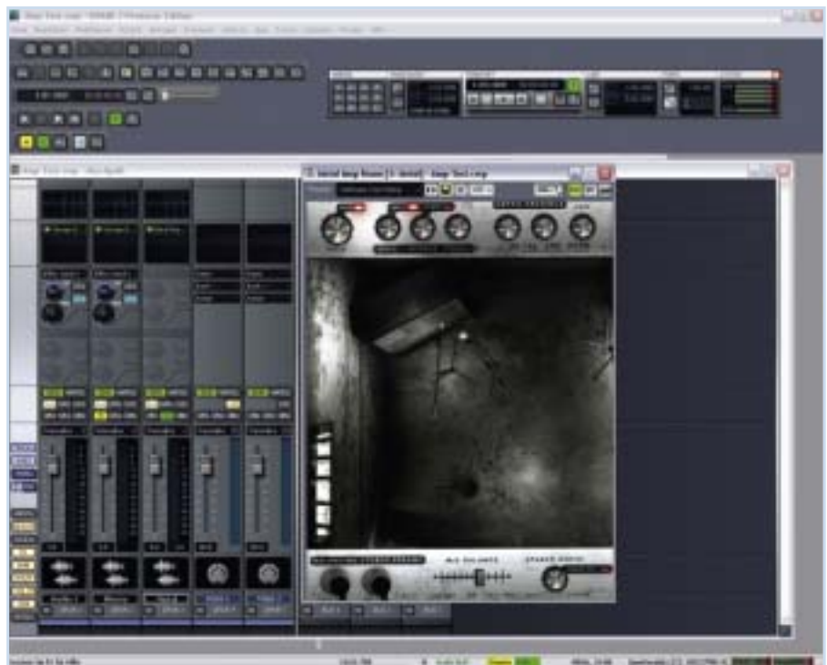
Der Metal Amp Room kommt mit nur einem Verstärker aus, der allerdings zwei unterschiedliche Kanäle hat: Der Clean/Crunch-Kanal entspricht dem White Amp aus dem Vintage Amp Room. Der Lead-Kanal ist eine Emulation des Engl Powerball. Eine passende Box (Engl E 412) hat Softtube auch emuliert.
