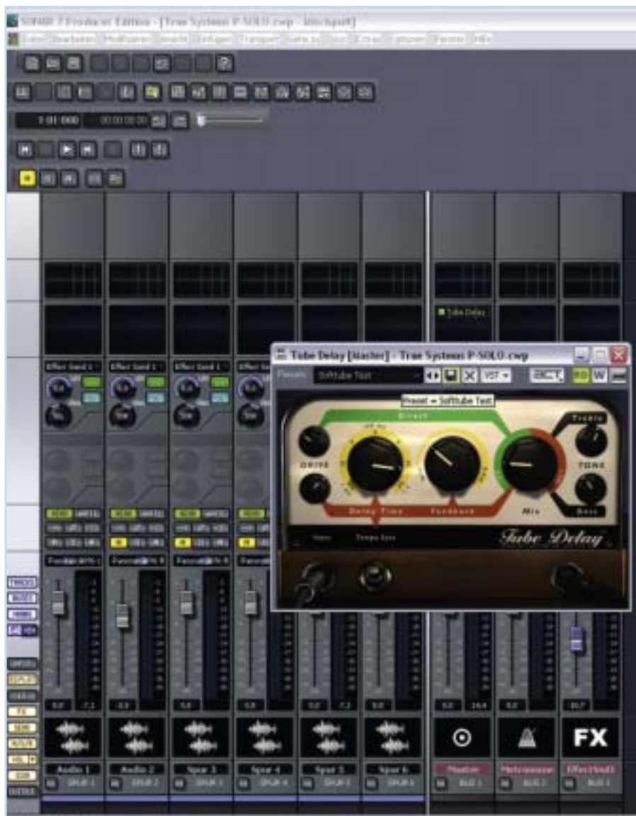
Tube Delay simuliert ein analoges Bandedgerät mit modellierter Röhrenstufe. Der Übersteuerungsgrad der virtuellen Röhren ist getrennt für das trockene Eingangssignal und des Delay-Signal regelbar. Wie der Federhall ist auch Tube Delay nicht auf gitarristische Anwendungen beschränkt.
